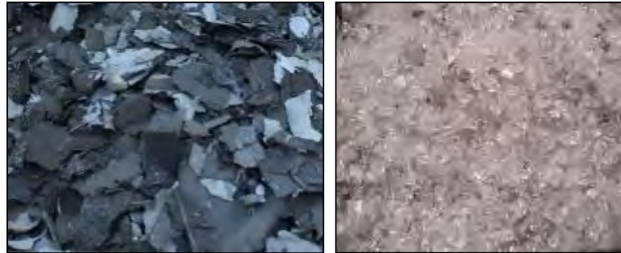
Figure 32 : Fragments de silicium et granulés de verre (Source : Soren, photovoltaïque.info)
