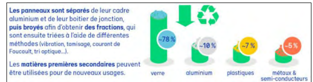
Figure 31 : Le traitement des panneaux photovoltaïques (Source : SOREN, 2022)
